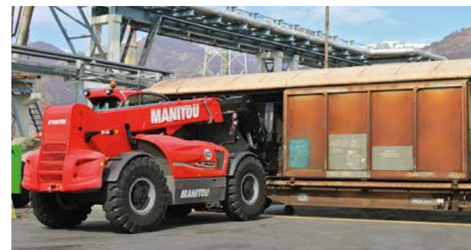
99% от изходната продукция на катодна мед в Аурубис България се товари от Manitou MHT10130
