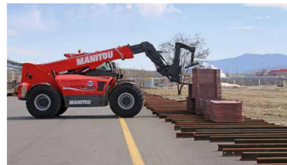
Manitou MHT10130 е модел без стабилизатори, но работи на далечно разстояние и с тежък товар благодарение на усилените си мостове
