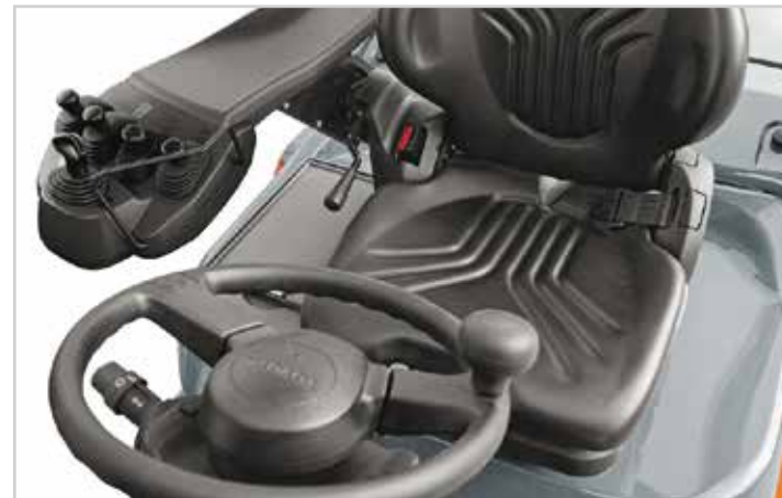
Регулируема, удобна и безопасна седалка с ORS система за сигурност, блокираща всички хидравлични функции при отсъствие на оператора.
