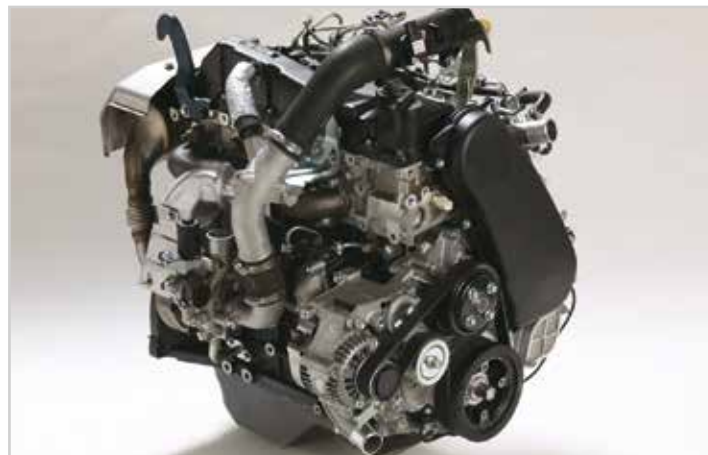
Чист модерен дизелов двигател Toyota 1KD тип комън рейл.
