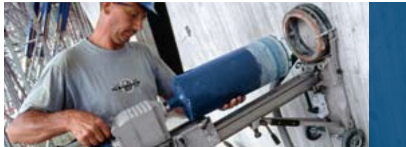
Мощно и без сътресение диамантено-пробивната машина GDB 2500 WE Professional пробива през бетон с арматурно желязо.
