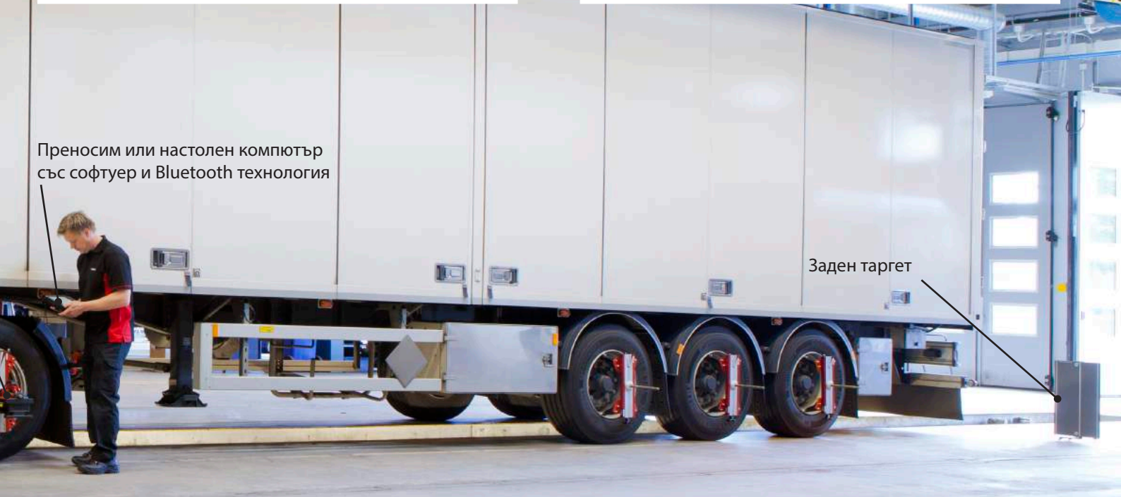
Гредата за ремаркета се използва при измерване на полуремаркета и ремаркета с количка
