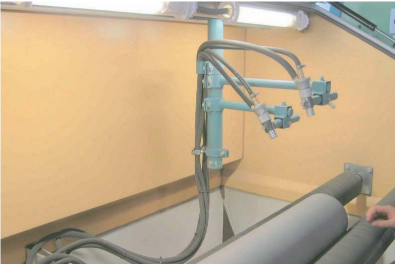
Automatische Drehvorrichtung für Rohre Automatic roller turning device for tube's
